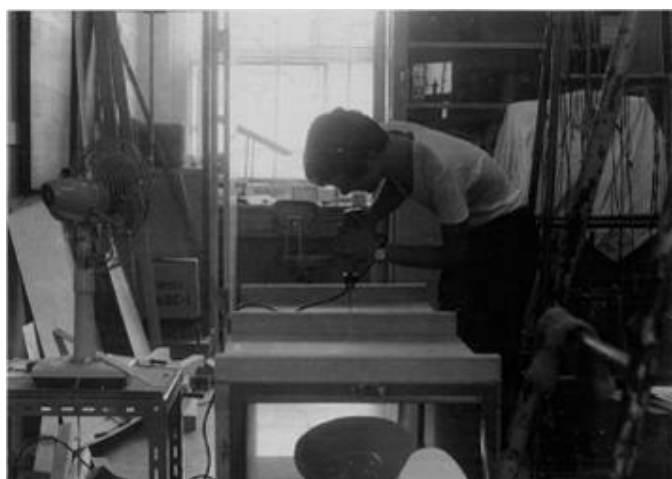
修士論文の研究のために実験装置 (風洞) を作製している様子。 (F46 小鍛治氏提供)
